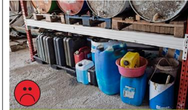
Il manque une cuve de rétention (à gauche). La cuve de rétention a un volume suffisant pour éviter les fuites de liquides (à droite).
