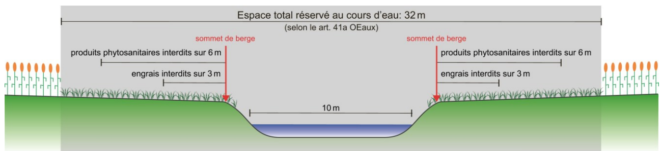
Fig. 2a: Méthode de mesure appliquée avant la détermination de l'espace réservé aux eaux: mesure depuis le sommet de la berge.
